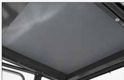
Het plafond bestaat uit geluidsabsorberend materiaal om het geluidsniveau laag te houden.
